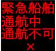
(図) 緊急船舶通航時の信号表示
